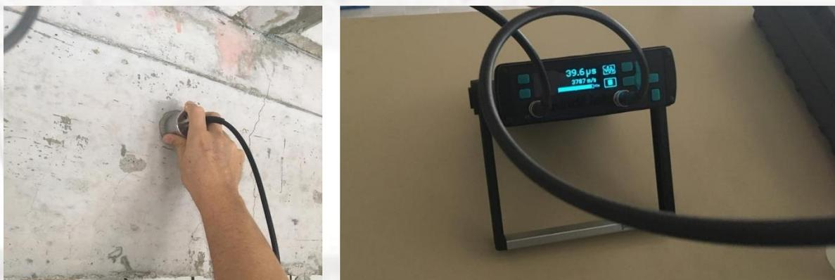
**Figura 12** – Realização do ensaio de velocidade de propagação do pulso ultrassônico.
