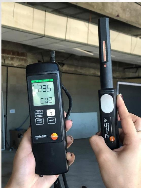
Figura 8 – Medidor de CO<sub>2</sub> empregado nas medidas realizadas.
