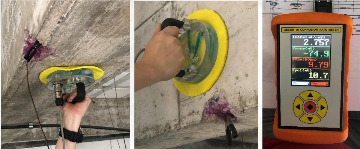
**Figura 16** – Realização do ensaio de densidade de corrente de corrosão.
