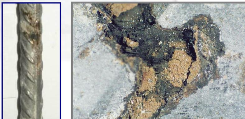
**Figura 3** – Exemplo da corrosão desencadeada pela ação dos cloretos (Fonte: acervo particular dos autores).
