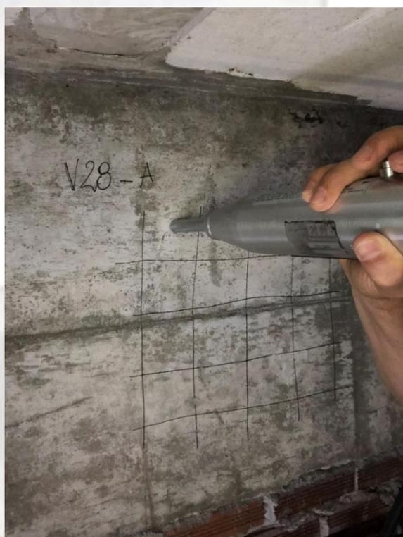
**Figura 10** – Ensaio de esclerometria.
